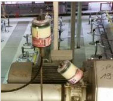
El tiempo de llenado se puede ajustar fácilmente desde el exterior. Los ciclos de llenado restantes se indicarán mediante el estado de LED.
