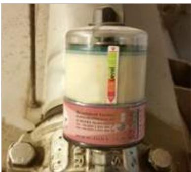
La recarga no es obligatoria, solo se hace necesaria si el lubricante se agota completamente y puede realizarse durante el funcionamiento de la máquina.
